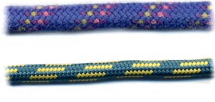
I cordini in nylon presentano una costruzione analoga a quella delle corde, sia come materiale che come procedimento di fabbricazione.
