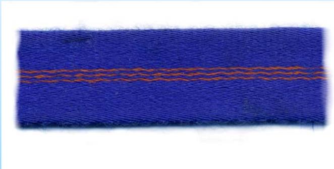
La resistenza di un anello di fettuccia si determina in base ai "fili spia", ogni filo corrisponde ad un carico minimo di 500 daN
