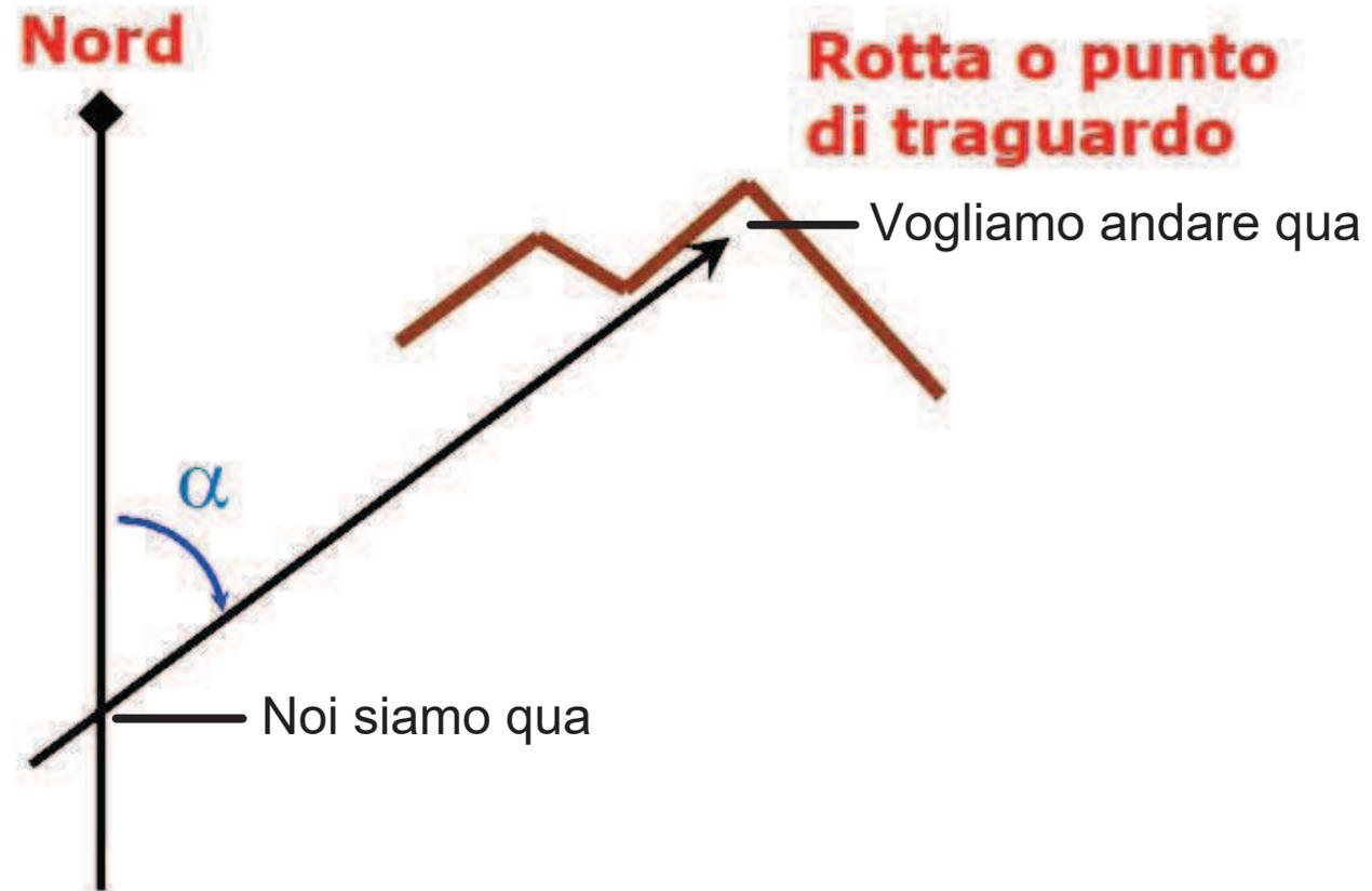
L'azimut è l'angolo fra la direzione del Nord e la direzione di un punto qualsiasi da seguire
